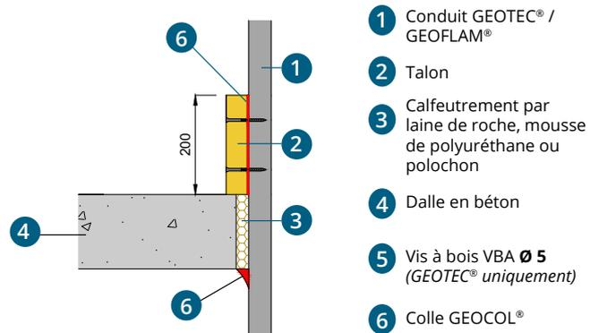
Talon utilisé comme renfort interne pour des conduits horizontaux GEOTEC®
