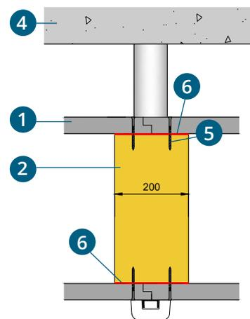
Talon utilisé comme renfort interne pour de grands conduits verticaux GEOTEC®
