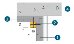
Tasseaux utilisés dans un conduit vertical lorsqu'il est accolé au mur
