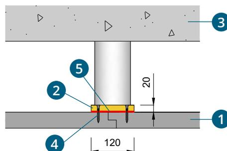
Couvre-joints utilisé pour renforcer la plaque supérieure des conduits horizontaux
