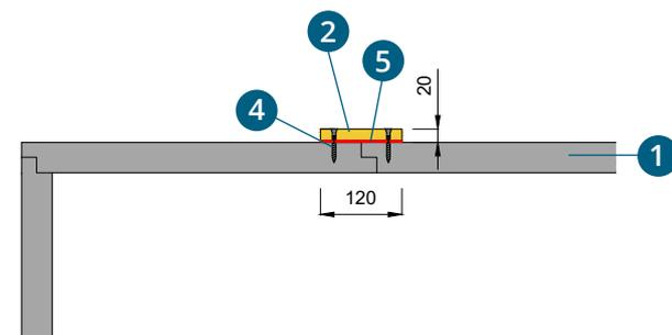
Couvre-joints utilisé pour renforcer de grands conduits verticaux
