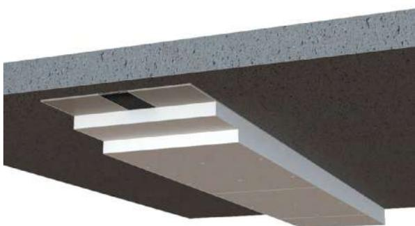
Dans cette configuration, un encollage au moyen de colle GEOCOL® est réalisé en périphérie du renfort en carbone. Une première épaisseur de protection en GEOTEC®S est fixée contre le béton au moyen de vis à béton à entraxe 400 mm dans les deux directions. La seconde épaisseur est quant à elle fixée à joints décalés sur la première au moyen de vis à bois à entraxe 200 mm dans les deux directions.
