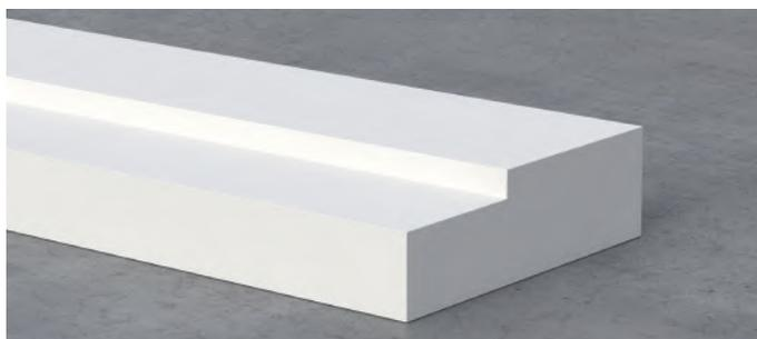
Élément pré-moulé à base de plâtre et de fibre de verre de 1,5 m de long, encollé sur le pourtour des conduits servant de presseur pour l'insertion de joints mousse et de joints intumescents ; il est destiné à reprendre les différents mouvements de la construction.
