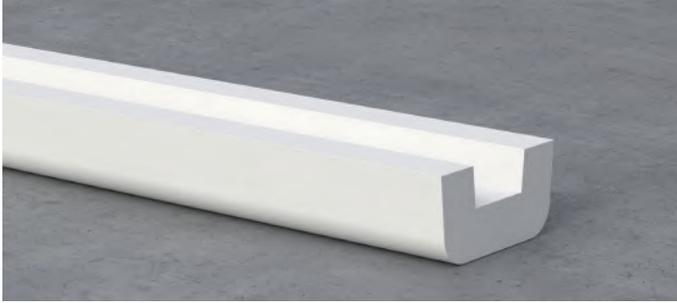
Composés principalement de plâtre et de fibre de verre, ces éléments pré-moulés sont destinés à protéger les supports métalliques des conduits horizontaux GEOTEC® et GEOFLAM®, EI 30 à 180 (coupe-feu de 30 min à 3 h).
