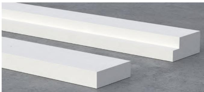
Composés principalement de plâtre et de fibre de verre, les demi-talons GEOTEC® A sont utilisés pour fixer des plaques GEOTEC® dans le montage de gaines techniques résistantes au feu à 1, 2 ou 3 côtés. Les demi-talons GEOTEC® A peuvent être installés à l'intérieur ou à l'extérieur des gaines techniques.
