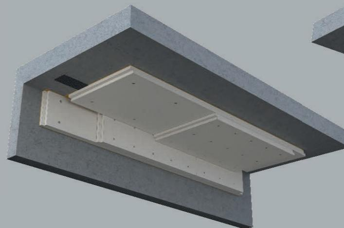
Dans ce cas particulier, la protection des éléments de renforts structurels devra être mise en oeuvre de manière identique à celle réalisée sous une dalle de béton : mêmes épaisseurs, mêmes débords et mêmes entraxes de fixation.
