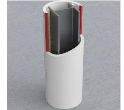
Les feuilures longitudinales de la 1<sup>ère</sup> ½ coque sont enduites de colle GEOCOL® puis la 2<sup>ème</sup> ½ coque est mise en place contre la 1<sup>ère</sup>.
