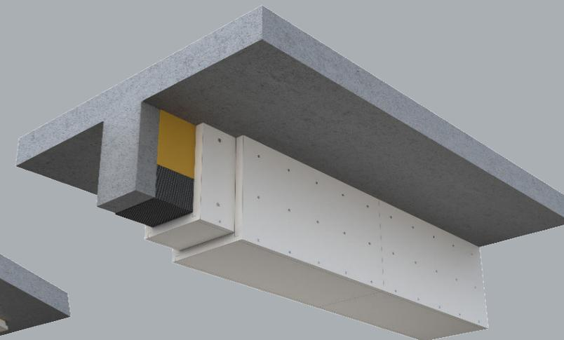
Dans cette configuration, l'habillage de la poutre (dans sa totalité) est mis en oeuvre sur les trois faces. Un encollage au moyen de colle GEOCOL® est réalisé en périphérie du renfort en carbone.
