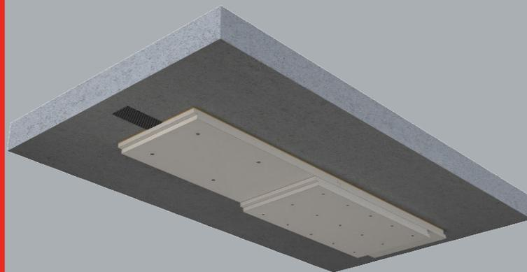
Dans cette configuration, un encollage au moyen de colle GEOCOL® est réalisé en périphérie du renfort en carbone.
