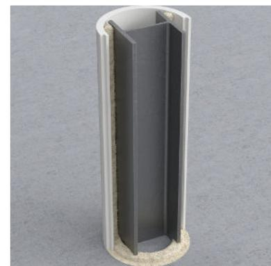
En pied du poteau, un polochon est constitué à l'intérieur des ½ coques en contact avec le sol et le poteau. Sur la 1<sup>ère</sup> ½ coque installée, deux polochons filants toute hauteur sont réalisés entre les semelles du poteau acier et la ½ coque.
